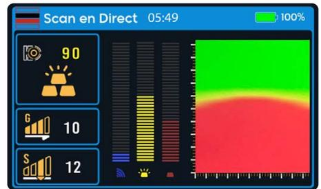
**Remarque:** La bobine V25 ne détecte pas les cavités ni les anomalies souterraines de type vide, c'est pourquoi aucun indicateur n'apparaît pour ce type de cibles en mode Live Scan.
