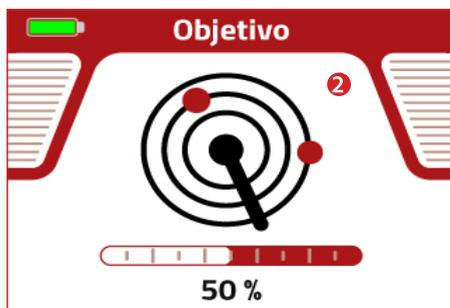
Sujeta el detector y avanza hacia la zona objetivo de búsqueda. Luego, espera la señal que será indicada por el movimiento de la antena. Cuando se detecte un objetivo, el detector lo mostrará en pantalla durante unos segundos, acompañado de un sonido interactivo, y luego continuará buscando otros objetivos.
