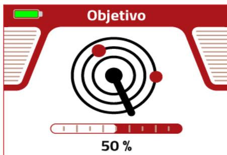
Al finalizar el proceso de búsqueda, los objetivos detectados aparecerán en la pantalla. Puedes navegar entre los diferentes objetivos utilizando las teclas de flecha. Presiona Aceptar **OK** para iniciar el rastreo del objetivo deseado.
