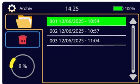
**Hinweis:** Die Speicherfunktion ist nur bei Verwendung der V-35Suchspule verfügbar und nicht mit anderen Suchmodulen nutzbar.
